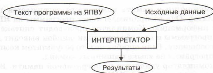
Рис. 2.20. Выполнение программы на ЯПВУ с использованием интерпретатора
