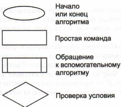
Рис. 1.8. Элементы блок-схем и структура «цикл»
