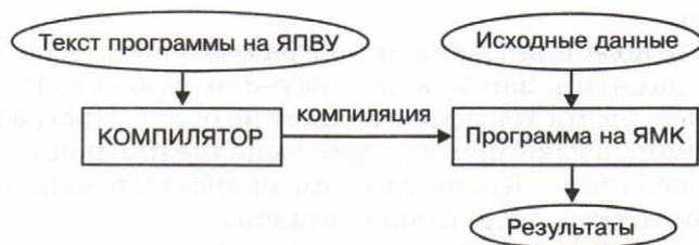
Рис. 2.19. Выполнение программы на ЯПВУ с использованием компилятора
